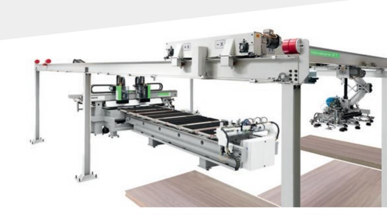
L'intégration avec le dépileur Winstore permet de gérer en mode automatique plusieurs panneaux, de formats et types différents, afin de répondre aux divers besoins du client, d'où une optimisation et un accroissement de la production.
